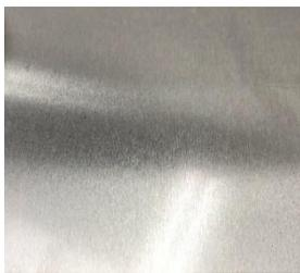
Eine Beschichtung mit Peco EGC ist homogen, glasklar, hauchdünn, UV-beständig, dauerflexibel, sehr temperaturbeständig und altert kaum. Hier im Beispiel ein Aluminiumsubstrat, dass im Tauchverfahren senkrecht beschichtet wurde.
