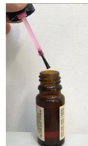
**- Zieht sich die Testtinte zusammen und kann keinen geschlossenen Film bilden, ist die Oberfläche beschichtet**
