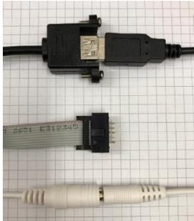
Erhöhung des Übergangswiderstand nach dem Beschichten mit Peco EGC nach dem ersten Stecken:
